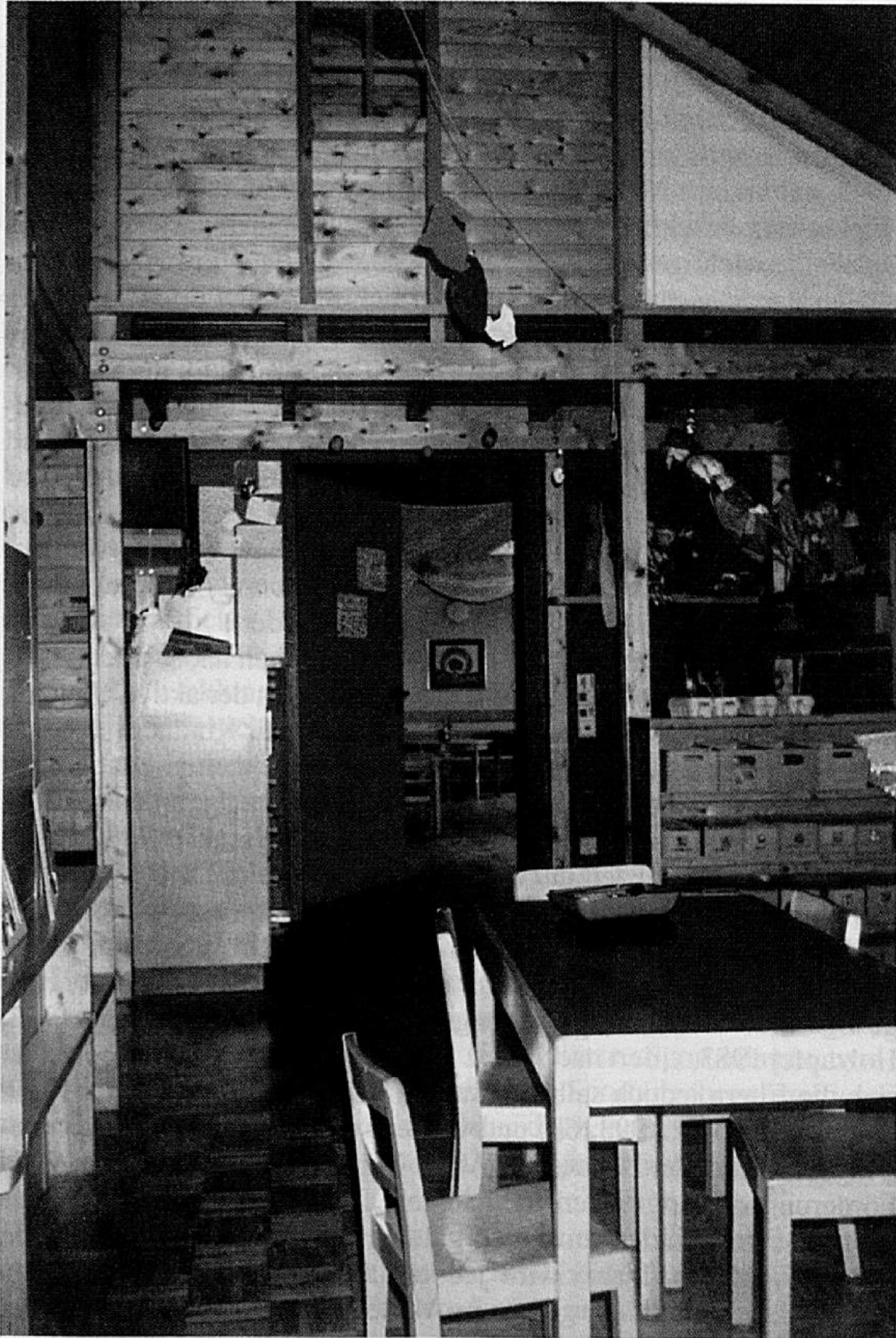
Abb. 22: Durch Podestüberbauten lassen sich auch Verkehrszonen an Ein- bzw. Ausgängen in der oberen Raumzone nutzen (St. Annaberg Kindergarten, Bingen; Foto: Inka Schmitz).
